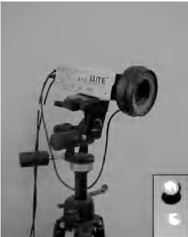
Figura 3 Cámara CCD y marcadores de infrarrojo (IR).
