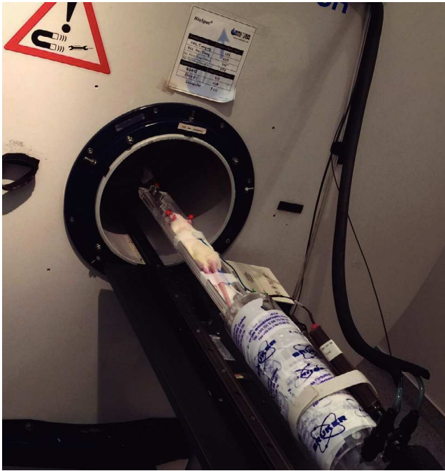
Figura 2 Durant les proves de ressonància magnètica es monitora la temperatura i la freqüència cardíaca als animals anestsats. S'obtingueren imatges sagitals en alta resolució de seqüències ràpides spin eco ponderades en T2 dels tendons rotular i contralateral lesionats.
